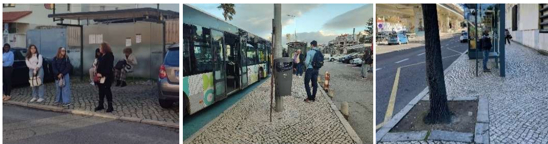
Figura 8.9 – Exemplos de obstáculos nos percursos pedonais de acesso às paragens de TPCR da AML (estacionamento abusivo, poste de eletricidade e mobiliário urbano, caldeira de árvores)
