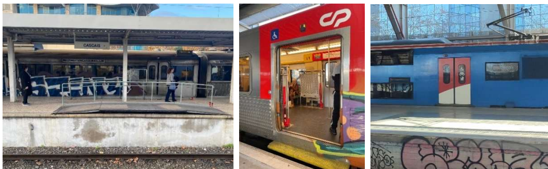
Figura 9.12 – Exemplos de acesso ao material circulante ferroviário na AML (rampa móvel de estação, rampa integrada na carruagem e piso rebaixado (ao nível da plataforma))
